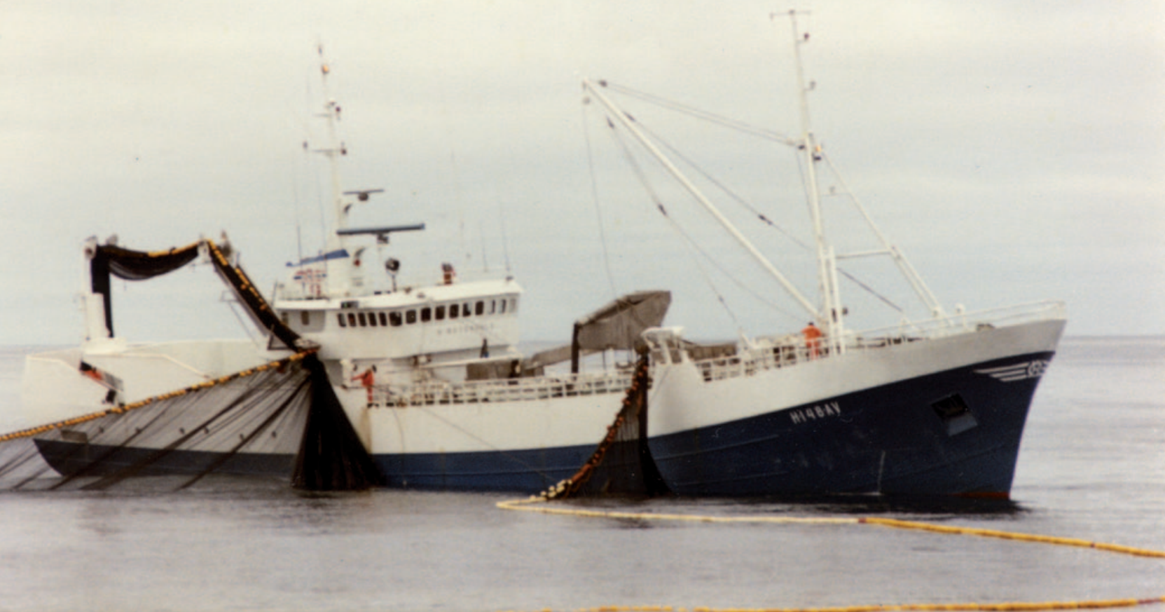
Ringnotsnurperen haler inn den enorme ringnota med kraftblokken. Fra 1960-årene ble de fleste fangstene av sild, makrell, lodde og kolmule tatt med slike høyeffektive havfiskebåter. Foto: Norges Fiskerimuseum
